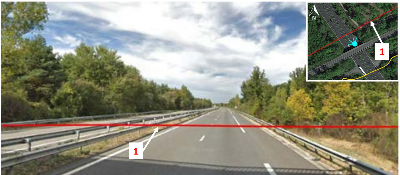
1 : Canalisation DN80 BRESSOLS – MONTECH GRDF projetée
