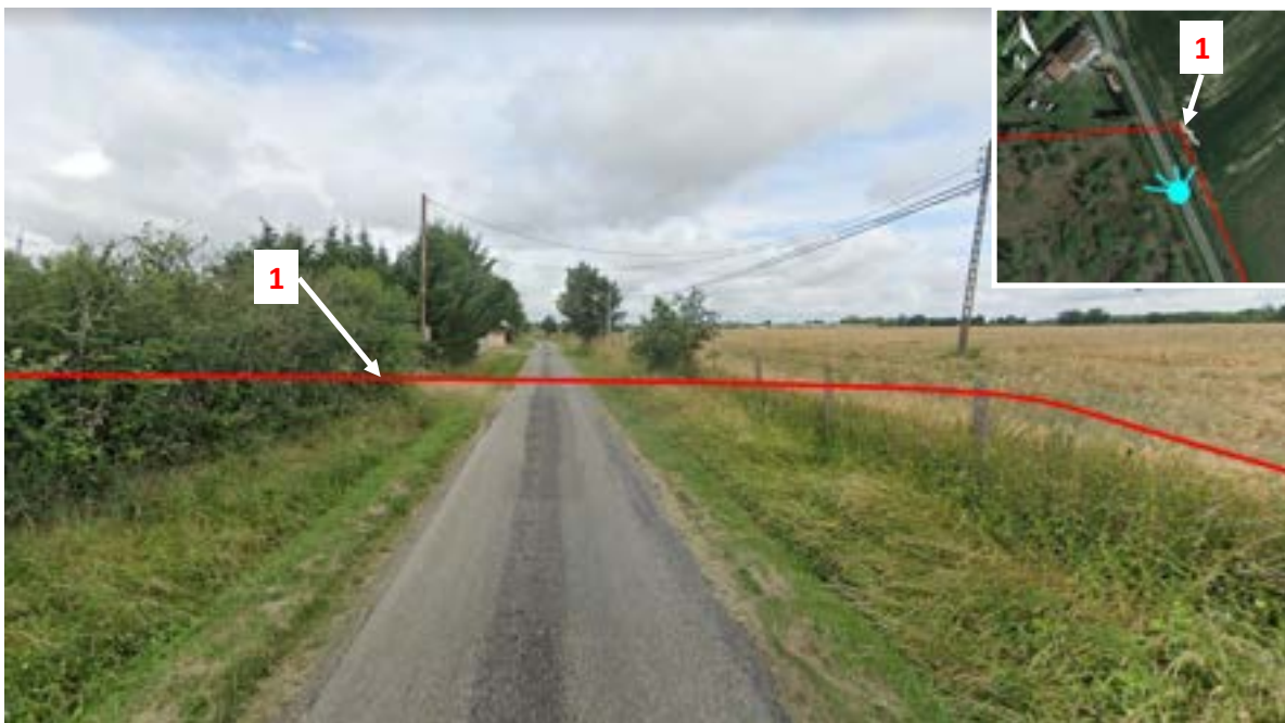
1 : Canalisation DN80 BRESSOLS – MONTECH GRDF projetée
