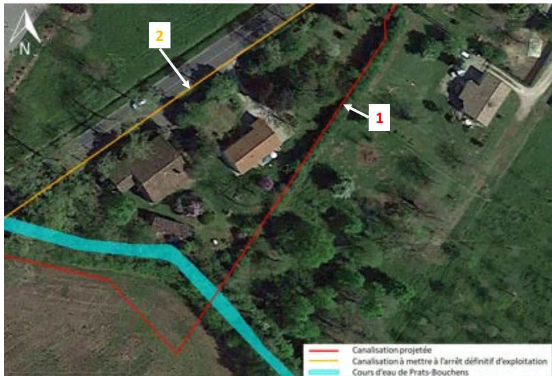
1 : Branchement DN80 GRDF MONTAUBAN ZI PARAGES projeté - 2 : Canalisation DN125 BOURRET – MONTAUBAN ZI PARAGES à mettre à l'arrêt définitif d'exploitation
