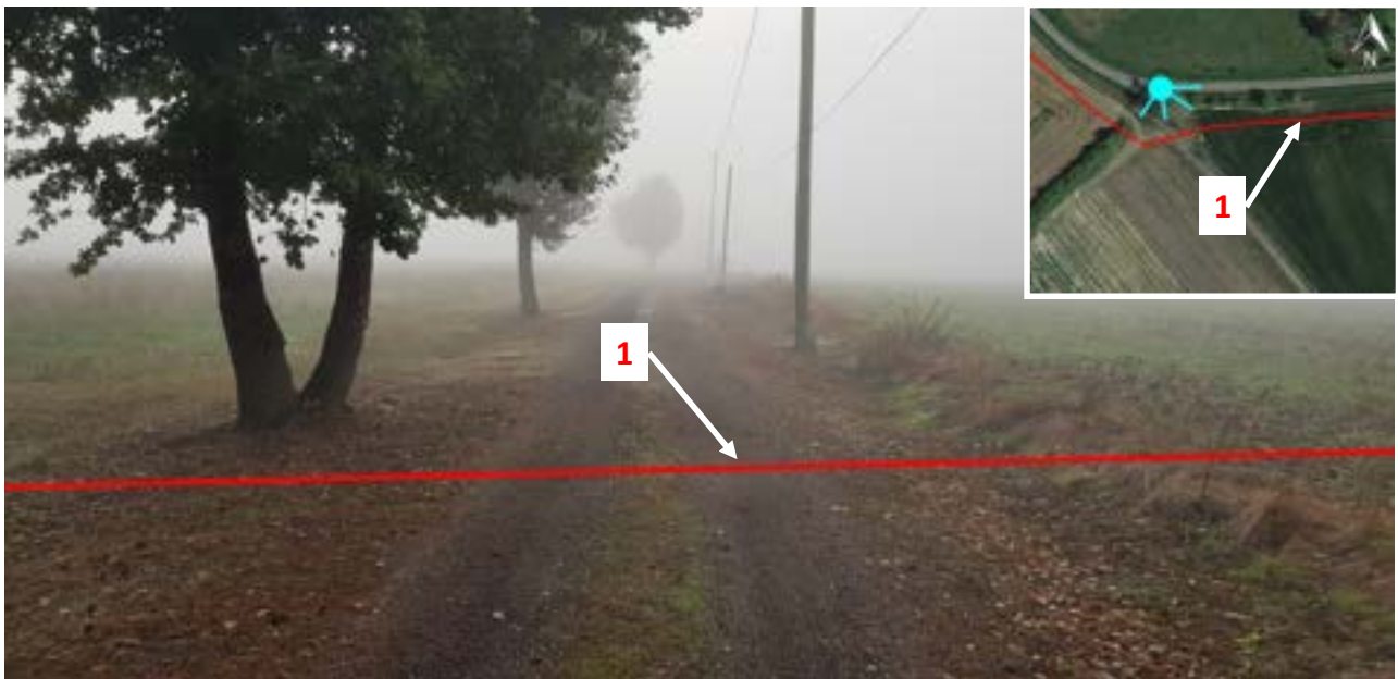
1 : Canalisation DN80 BRESSOLS – MONTECH GRDF projetée
