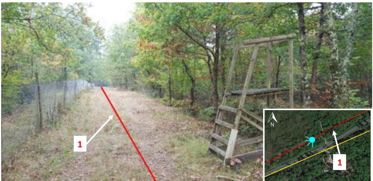
1 : Canalisation DN80 BRESSOLS – MONTECH GRDF projetée
