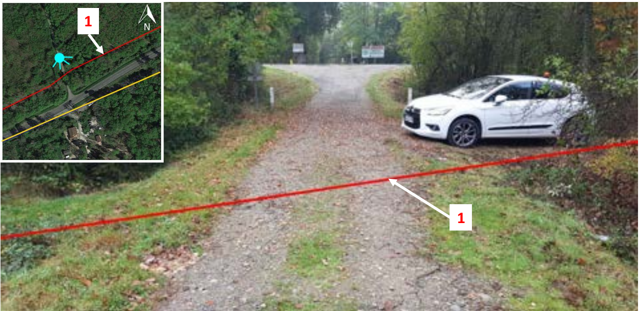
1 : Canalisation DN80 BRESSOLS – MONTECH GRDF projetée
