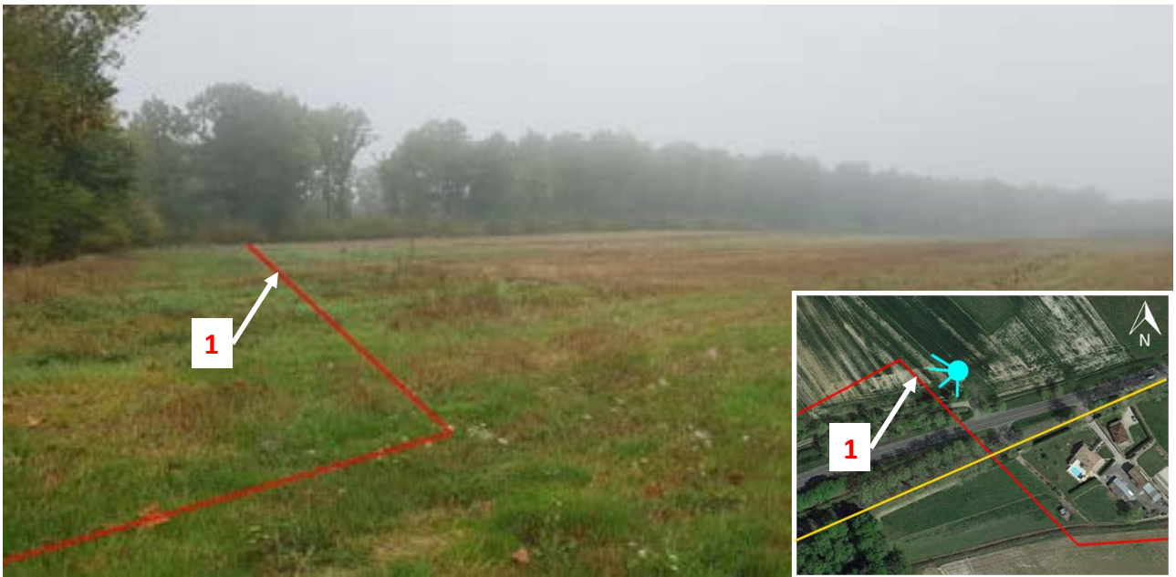
1 : Canalisation DN80 BRESSOLS – MONTECH GRDF projetée
